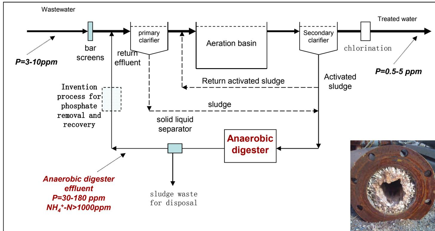
struvite,  $\text{MgNH}_4\text{PO}_4 \cdot 6(\text{H}_2\text{O})$
